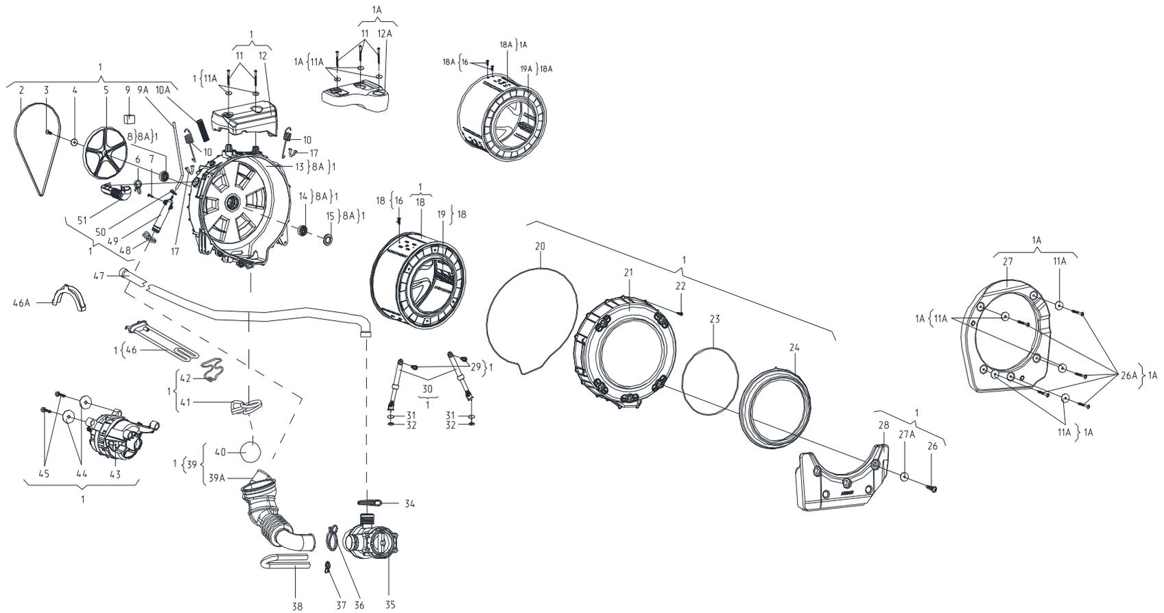
Рисунок 4 - Колебательная система
