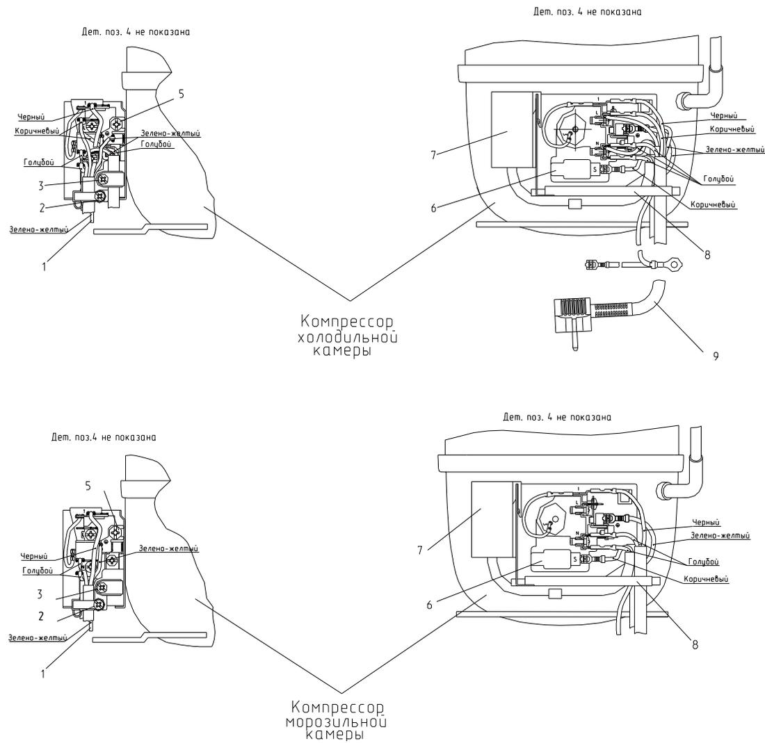
Рисунок 11 - Комплект пусковой (применяется с компрессором ф. "ACC")
