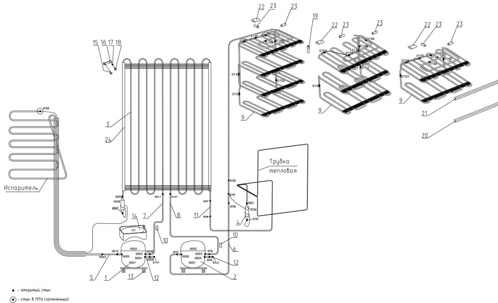
Рисунок 12 - Схема холодильного агрегата (ЕМУ)
