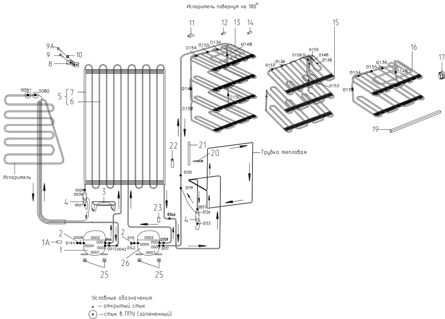
Рисунок 4 - Схема холодильного агрегата (компрессор типа С-КН)
