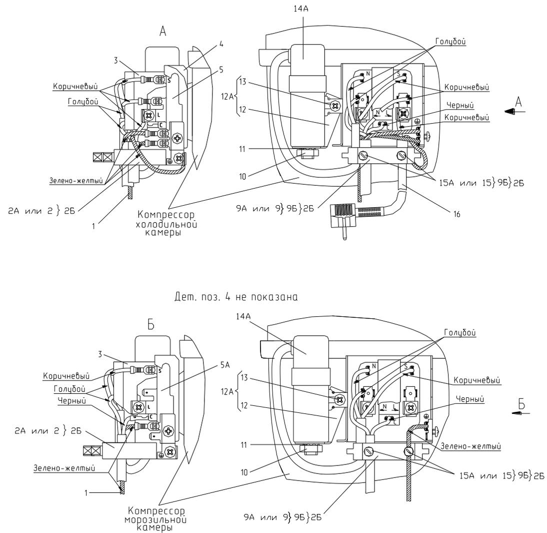
Рисунок 8 - Комплект пусковой (применяется с компрессором типа TLX и CTC)
