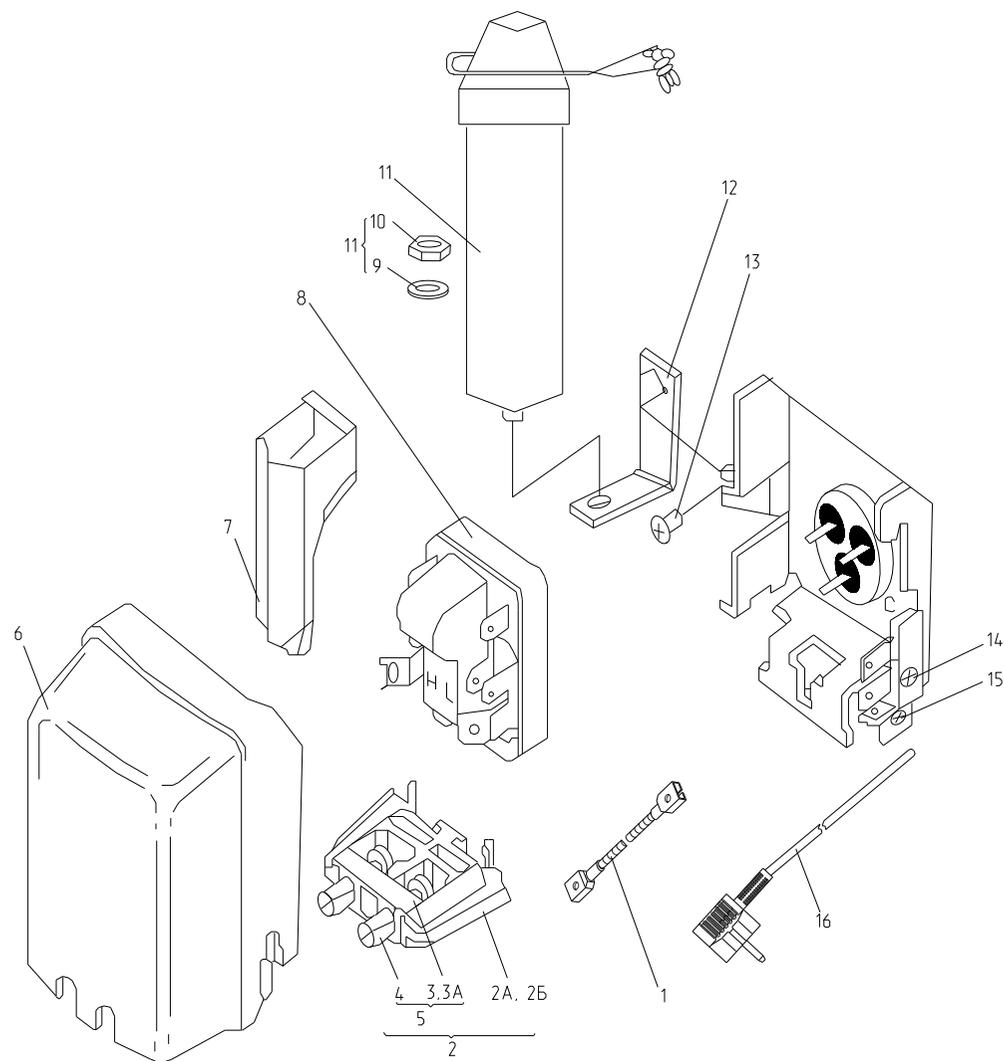
Рисунок 9 - Комплект пусковой (применяется с компрессором типа DLX)
