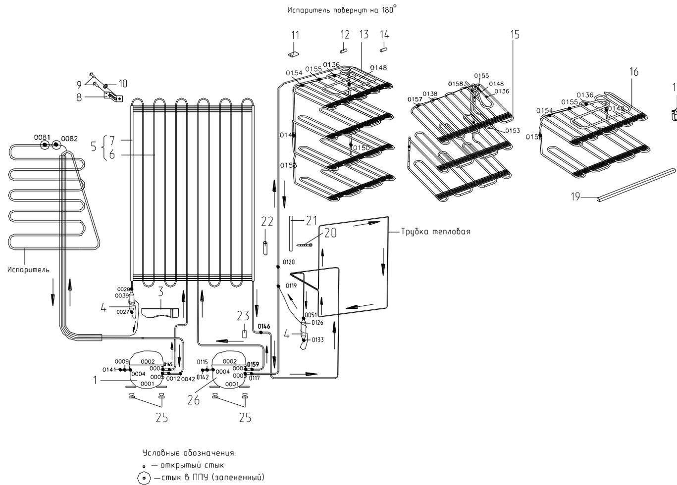
Рисунок 5 - Схема холодильного агрегата (компрессор типа АСС)
