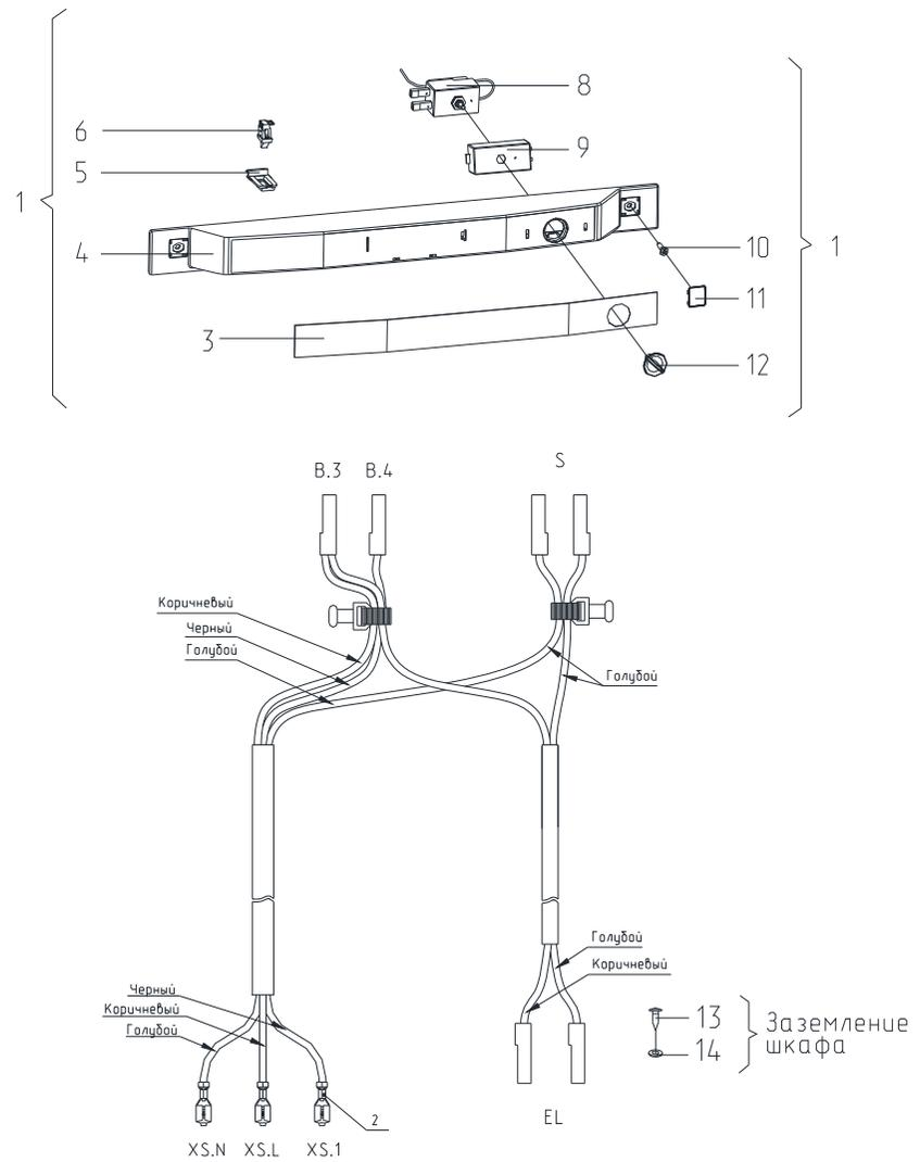
Рисунок 5 - Электропроводка
