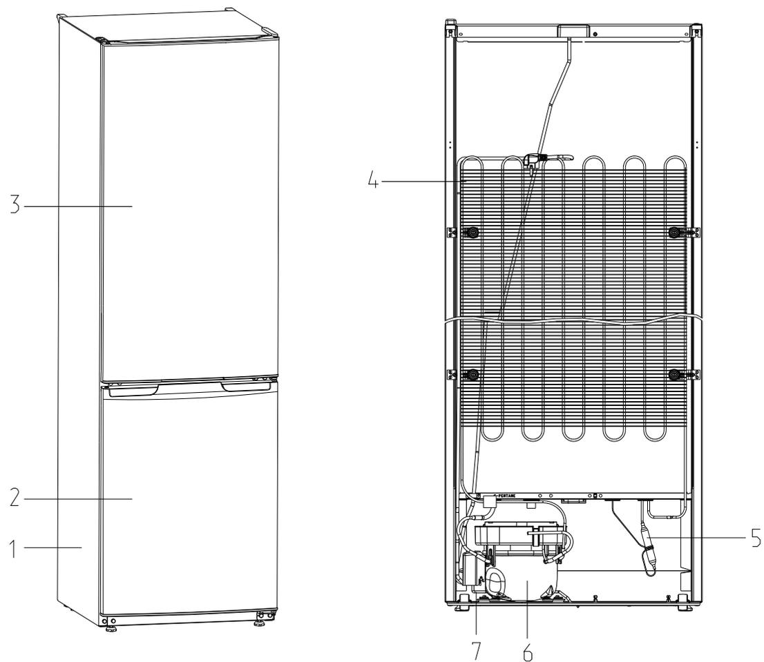
1-шкаф, 2-дверь, 3-дверь, 4-конденсатор, 5-фильтр-осушитель
