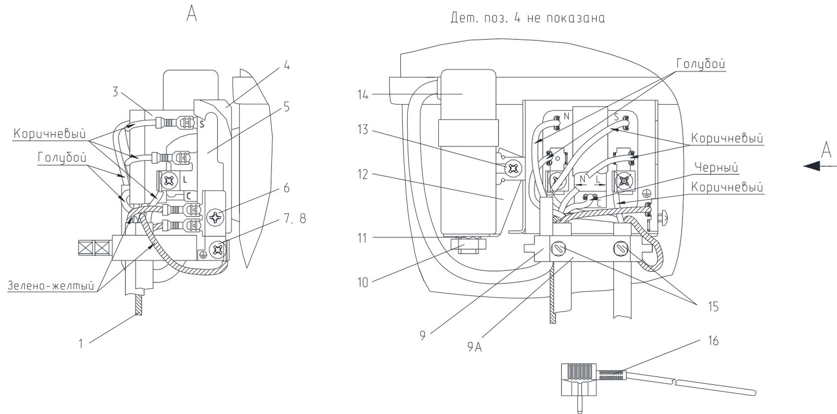
Рисунок 6 - Комплект пусковой (с компрессором NLX)
