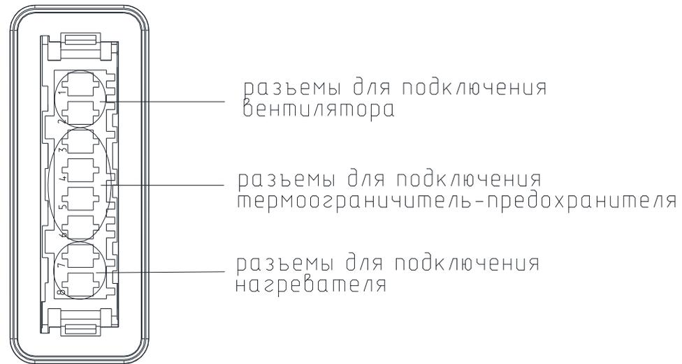
Рисунок А.2.1- Схема подключения разъемов МК
