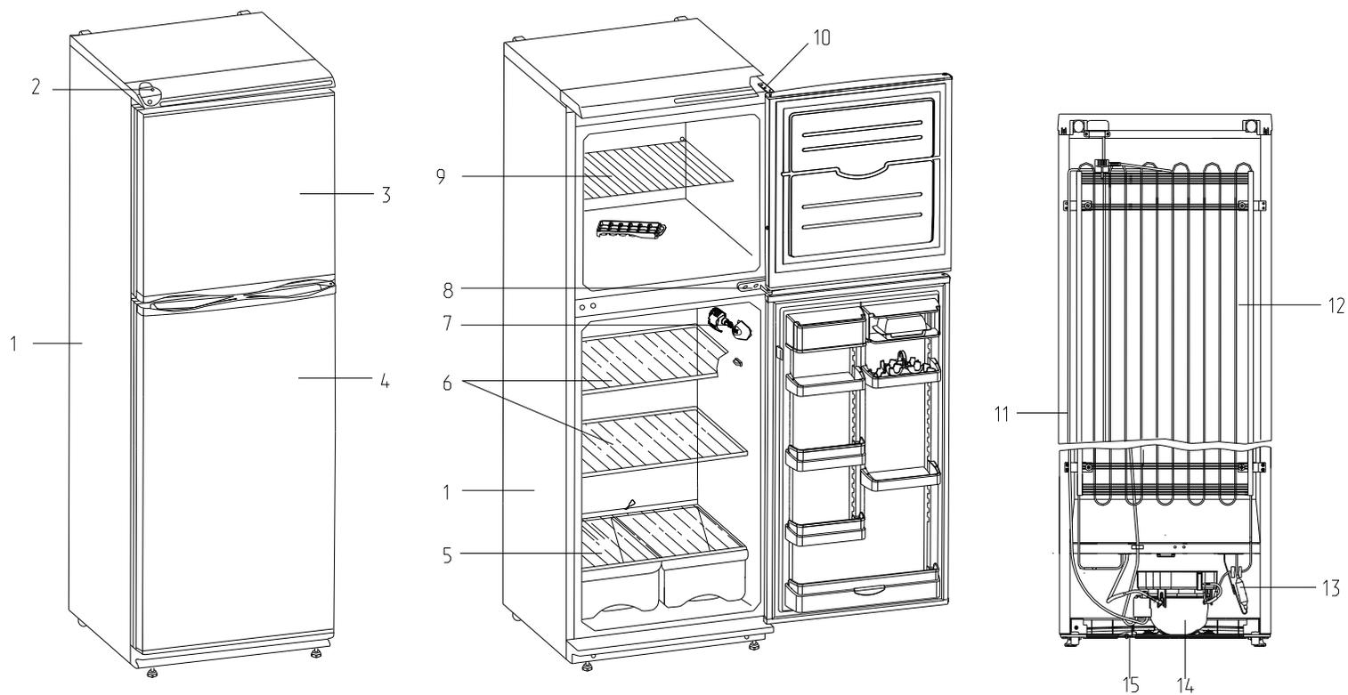
1 - шкаф, 2 - опора терморегулятора, 3 - дверь, 4 - дверь, 5 - полка-стекло,
