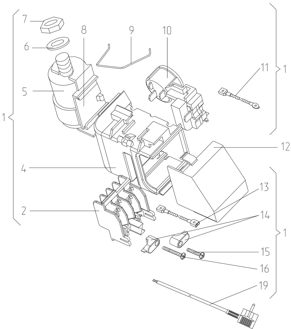
Рисунок 9 - Шнур питания (применяется с компрессором типа С-КН)
