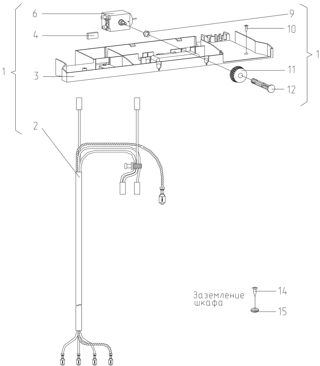
Рисунок 6 - Электропроводка
