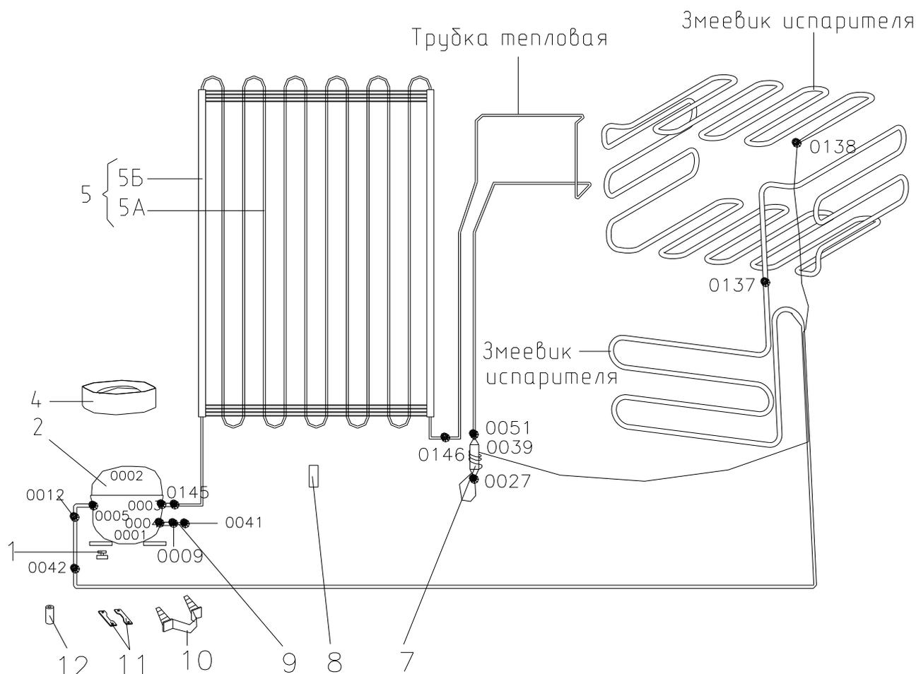
Рисунок 5 - Схема холодильного агрегата (компрессоры типов CTC)
