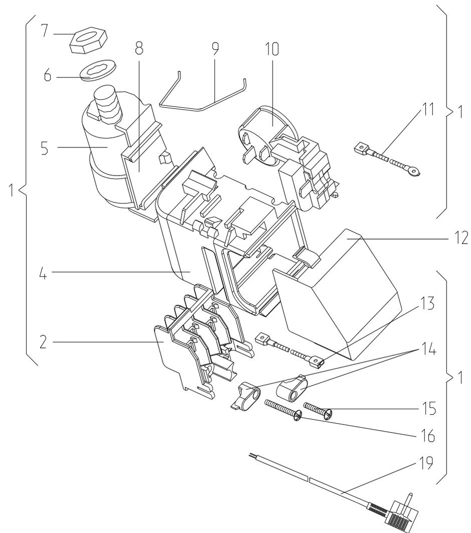
Рисунок 7 - Шнур питания (применяется с компрессором типа СТВ)
