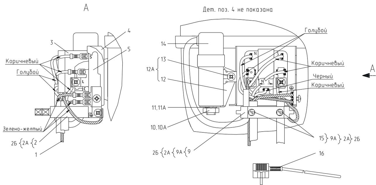
Рисунок 10 - Комплект пусковой (применяется с компрессорами типов TLX)
