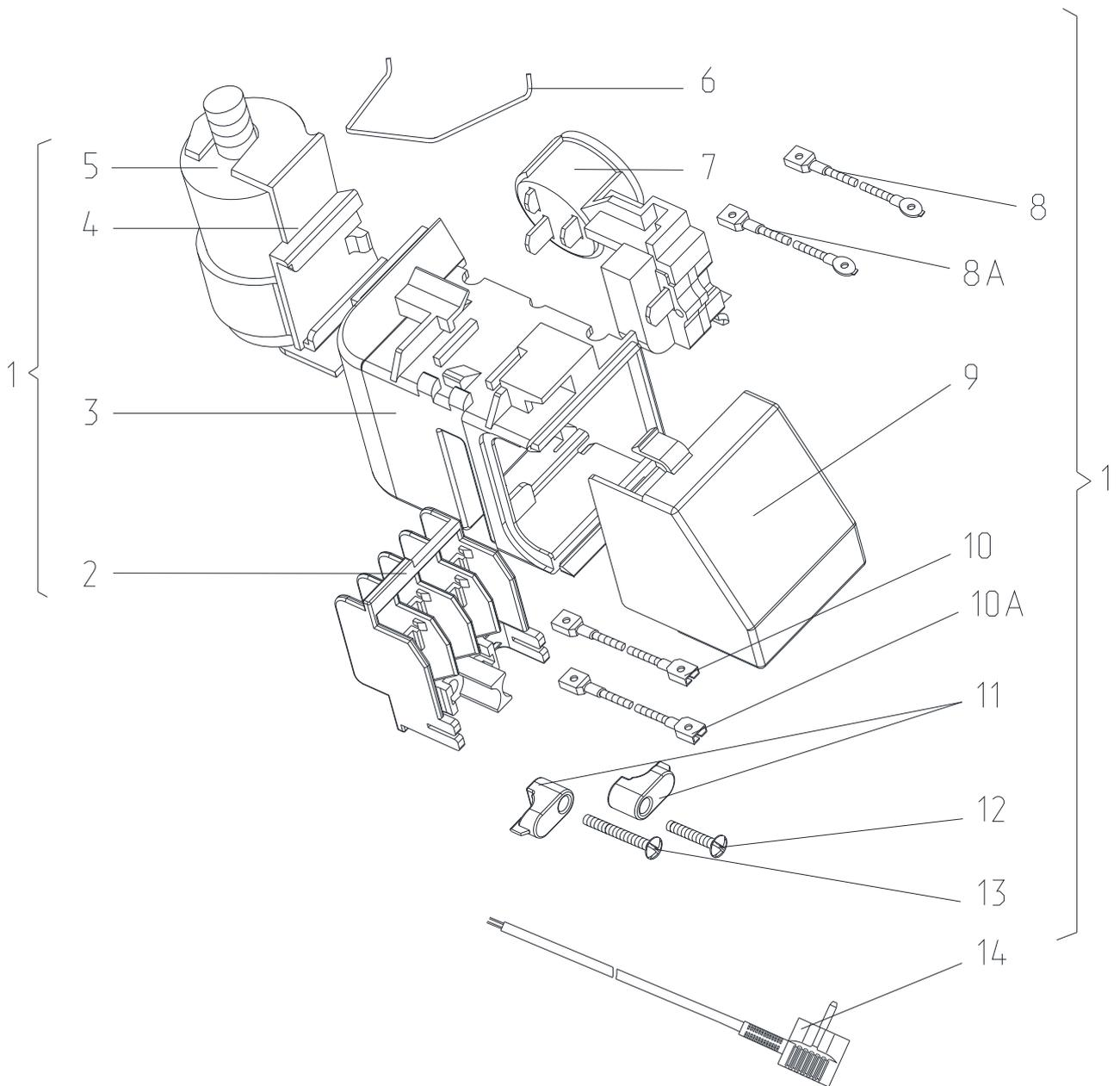
Рисунок 6 - Шнур питания (применяется с компрессором СТВ, СТС)
