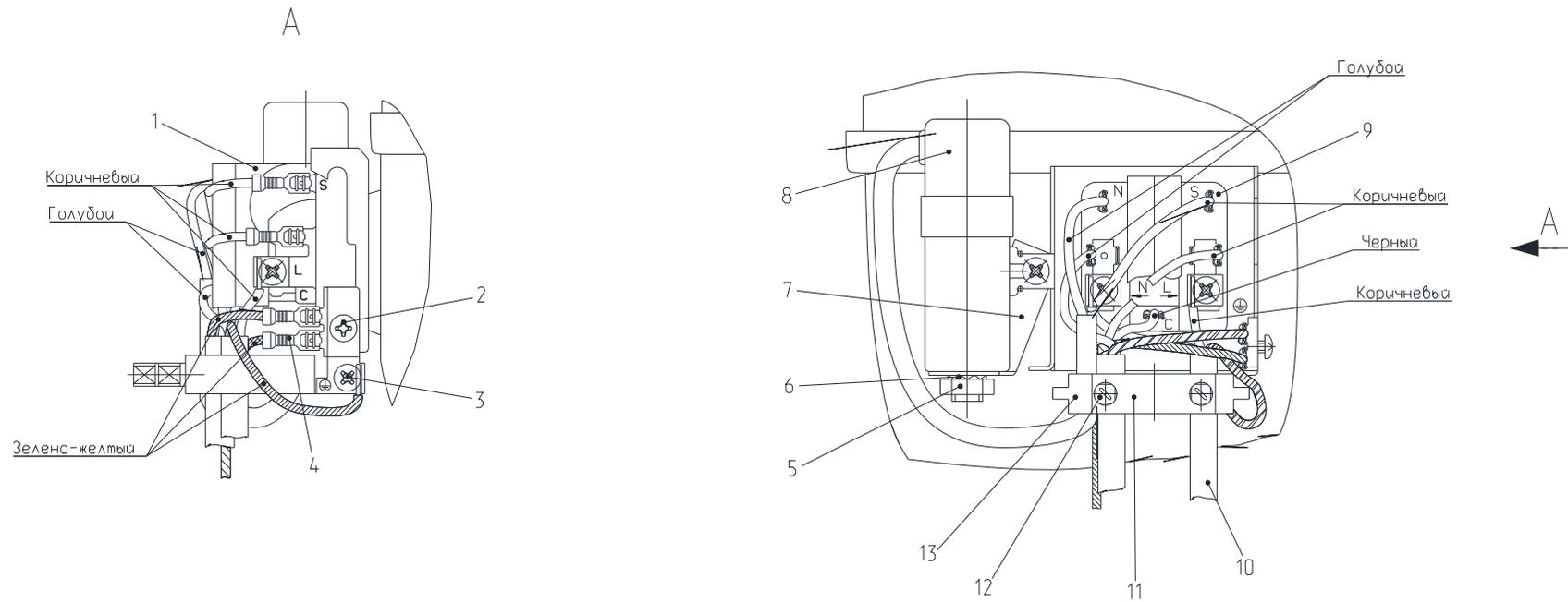
Рисунок 7 - Комплект пусковой (применяется с компрессором NLX)
