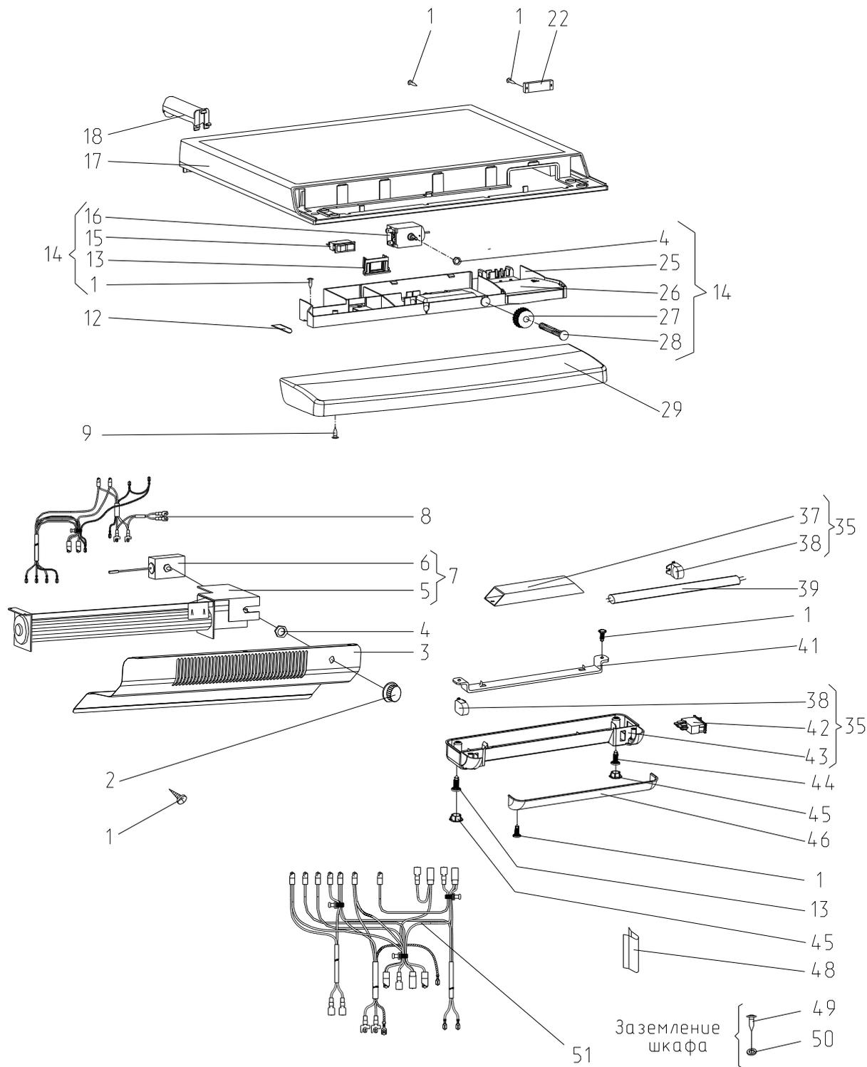
Рисунок 6 - электропроводка
